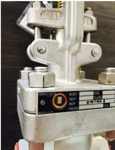
RFID-метки на арматуре
