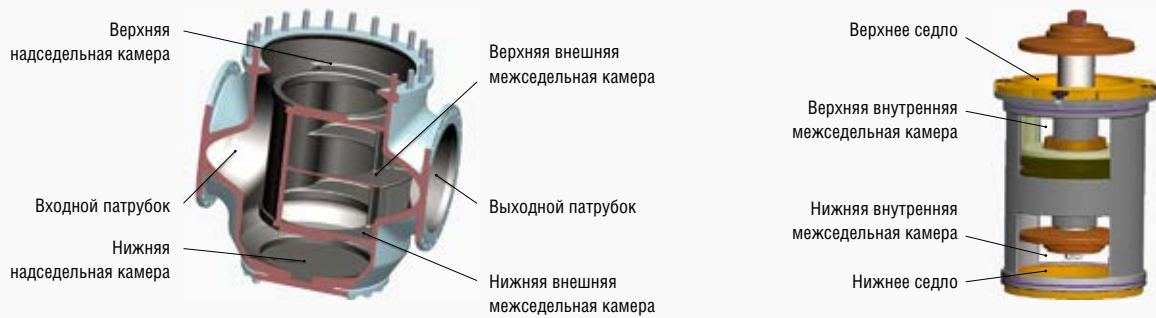
Рис. 2. Проточная часть клапана ТЕЗАУРУС
