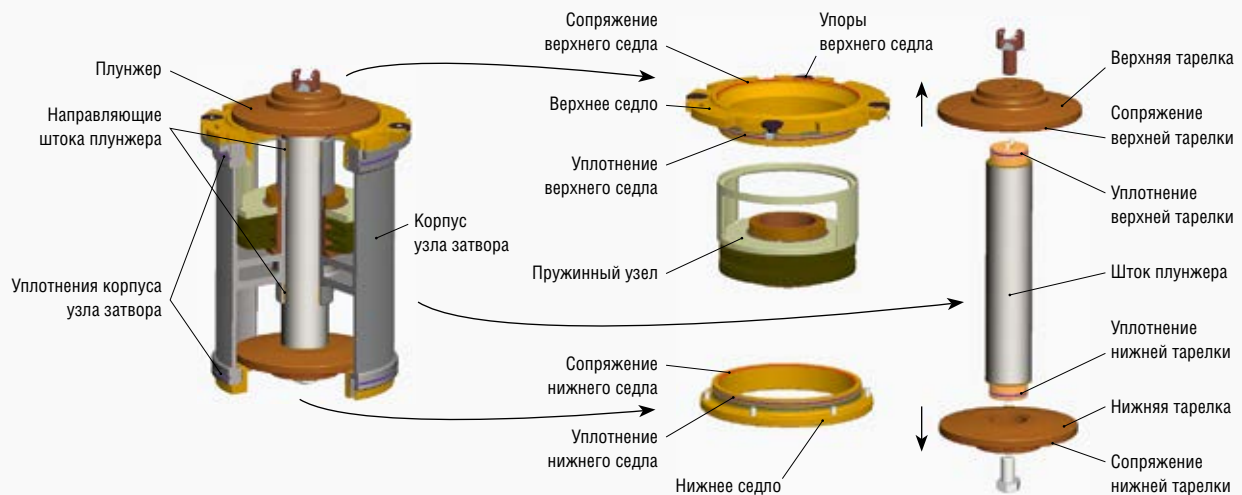
Рис. 4. Конструкция узла затвора клапана ТЕЗАУРУС
