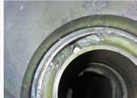
Рис. 5. Уплотнение, разрушенное в результате явления «взрывной декомпрессии»
