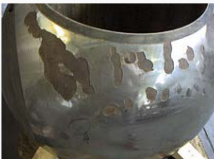
Рис. 4. Повреждение покрытия шаровой пробки [2]
