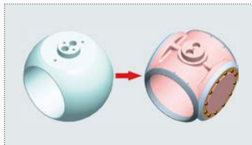
Рис. 9. Замена № 2 – в «УМНЫЙ» кран установлен запорный орган, имеющий сферическую рабочую поверхность только на кольцах.
