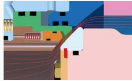
Рис. 13. Отвод из потока рабочей среды подвижного уплотнительного элемента из полимера и защита его от эрозионного износа в начале поворота запорного органа крана
