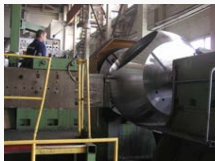
Рис. 2. Обработка шаровой пробки крана большого типоразмера [1]
