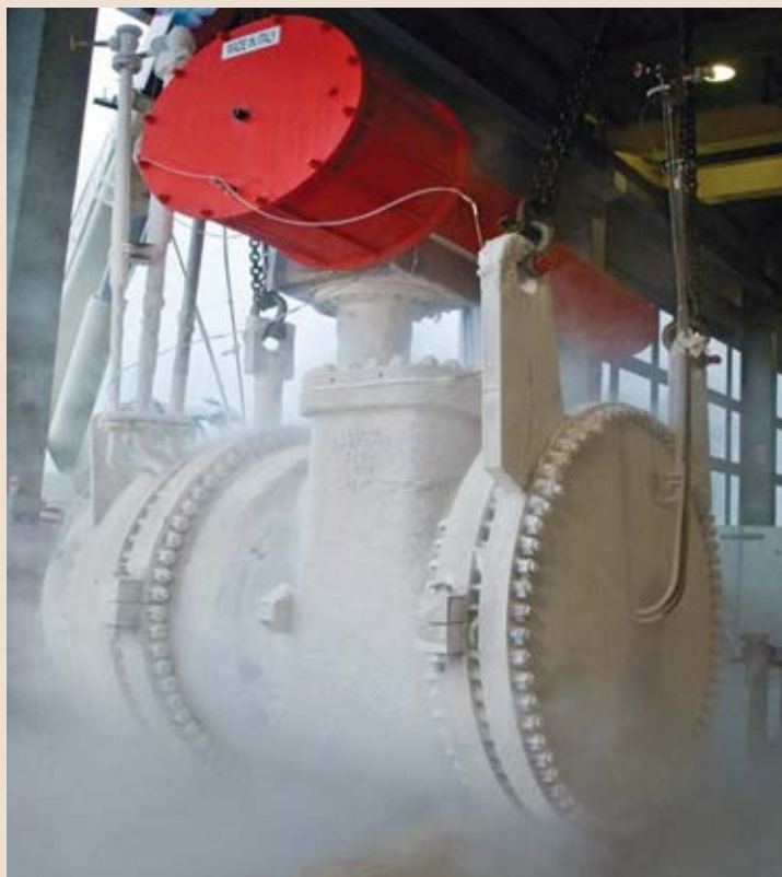
Рис. 7. Поворотный дисковый затвор BWT компании IMI Orton с тройным эксцентриситетом и металлическим уплотнением в затворе после испытаний в криогенных условиях (конструкция со сборкой сверху)
