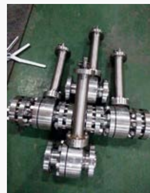
Краны шаровые DN 50, PN 40 среда – хлорид циркония
