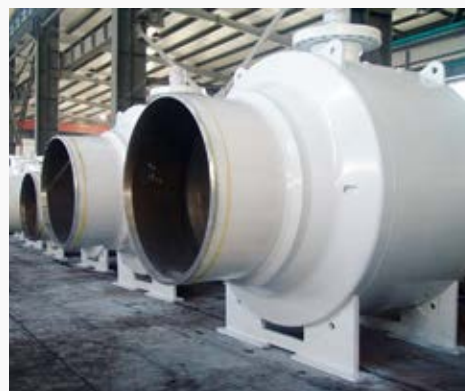
Краны шаровые DN 1200, PN 1,6 МПа для магистральных газопроводов
