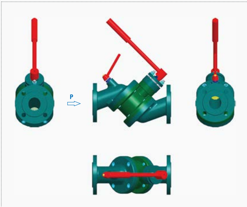
Рис. 2. Шаровой кран с регулируемым поджатием и изменяемой геометрией корпуса [4]
