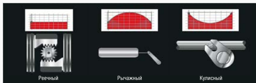
Рис. 1. Механизмы преобразования линейного движения во вращательное в пневмоприводах
