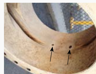
Повреждения покрытия в области седла
