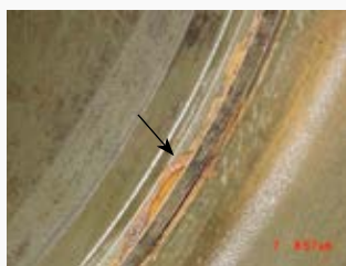
Коррозия под уплотнительным кольцом седла
