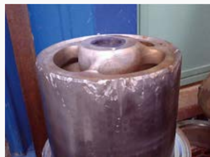
Рис. 12. Детали отказавшего клапана Моквелд в оборудовании отечественного газодобывающего предприятия
