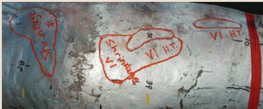
Дефекты (подобные показанным) чаще всего встречаются в литой арматуре с высоким содержанием хрома, используемой, например, для ultrasupercritical параметров пара
