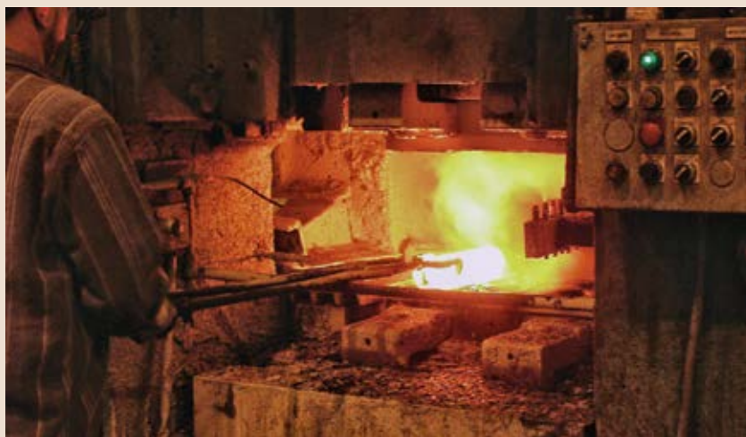
Прутки или заготовки, применяемые для изготовления деталей арматуры методомковки, нагреваются до высокой температуры и затем с помощью специальной оснастки им придается заданная форма. Получение небольших корпусов арматуры методом объемной штамповки
