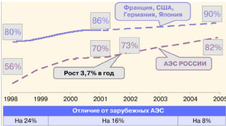
Рис. 8. Коэффициент использования установленной мощности атомных станций.
