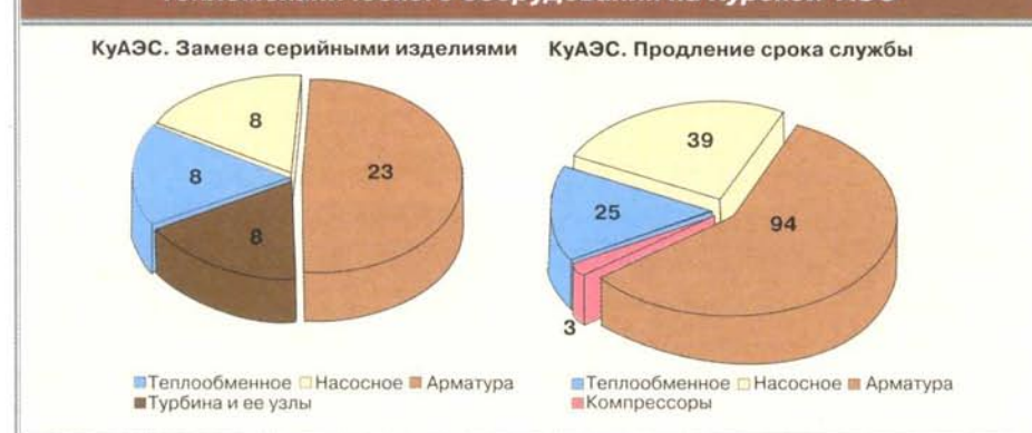
Рис. 7. Данные о замене, модернизации и продлении срока службы тепломеханического оборудования на Курской АЭС
