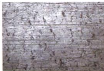
число циклов нагружения: N = 30 тыс.
