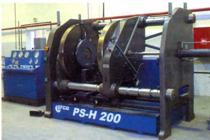
Испытательный стенд фирмы EFCO PS-H 200 для испытания арматуры диаметром DN до 2000 мм
