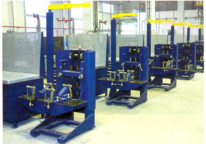
Рабочие места для разборки-сборки арматуры PMP-5 (ПКТБА, г. Пенза)
