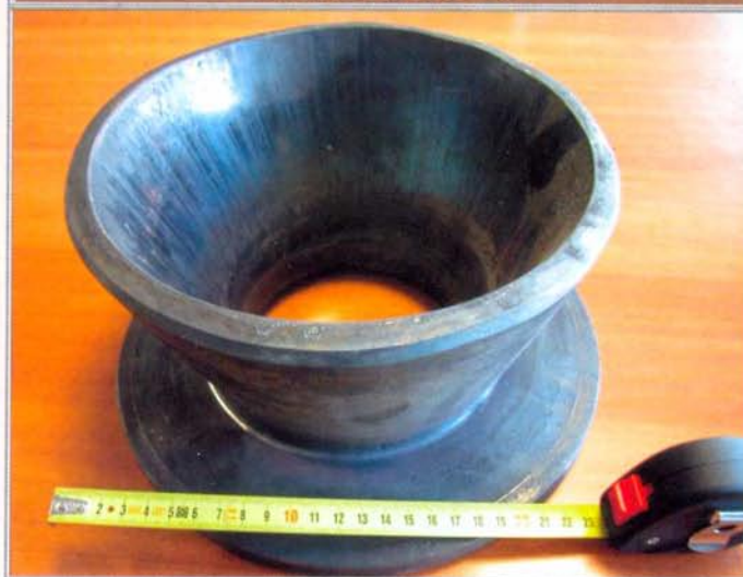
Рис. 3. Поковка фланцевого перехода, отштампованная на прессе тройного действия 2000/1000/1000 тс
