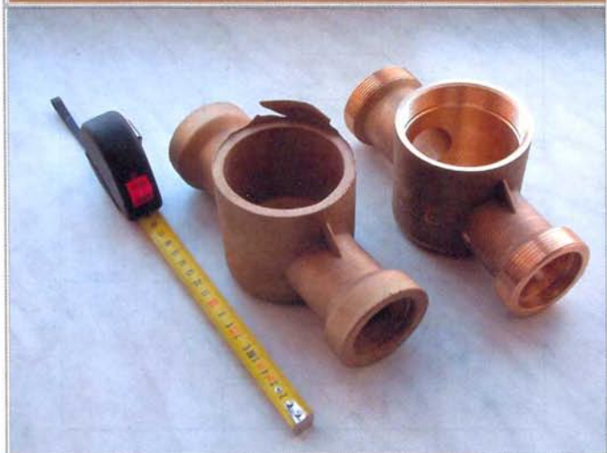
Рис. 8. Корпус водосчетчика DN 40 завода «Водоприбор», отштампованный на прессе тройного действия
