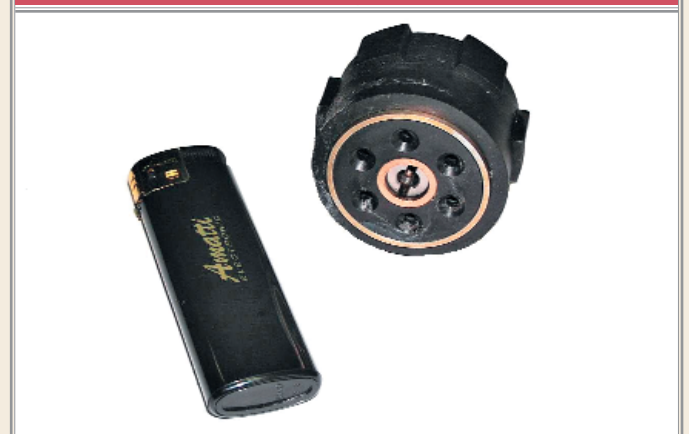
Рис. 2. ПЦР, изготовленные методом термопластмассового литья
