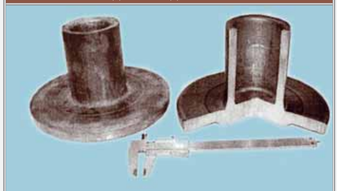
Рис. 5. Поковки, полученные комбинированным выдавливанием на гидравлическом прессе двойного действия
