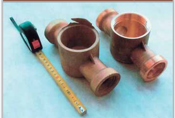
Рис. 4. Поковки корпуса водосчетчика на Ду 40 после штамповки (слева) и механообработки
