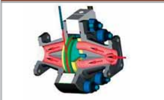
Рис. 4. Затвор в положении «открыто»
