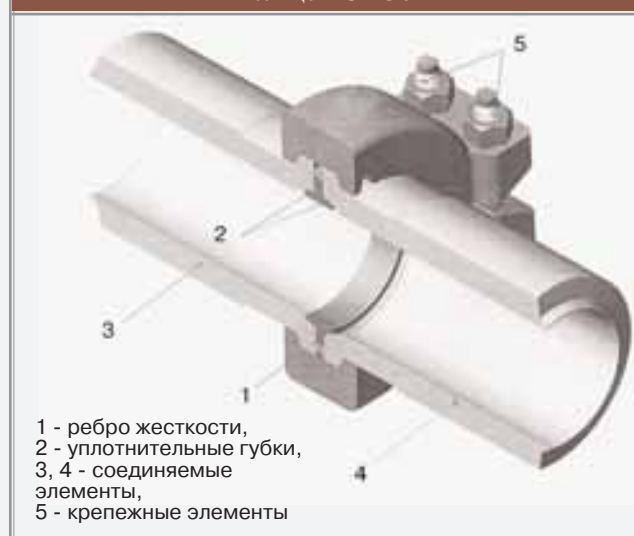
Рисунок 2. Бугельное соединение с уплотнительным кольцом СКОУ
