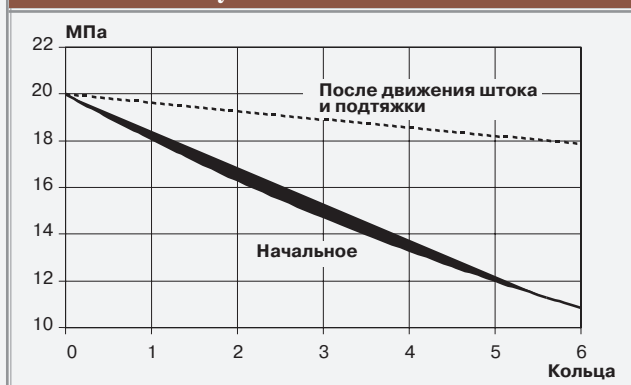
Рис. 2. Распределение боковых напряжений для сальниковых уплотнений из ТРГ при различных условиях монтажа
