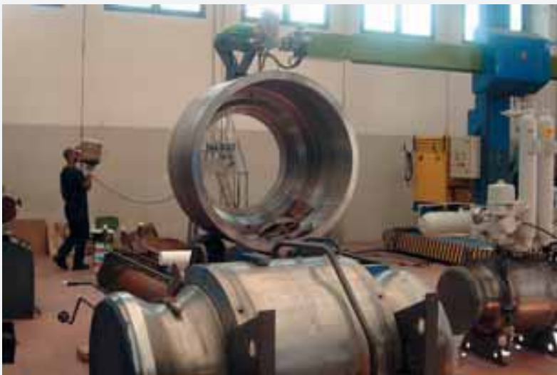
Сварка швов на корпусе крана в Velan S.r.l.
