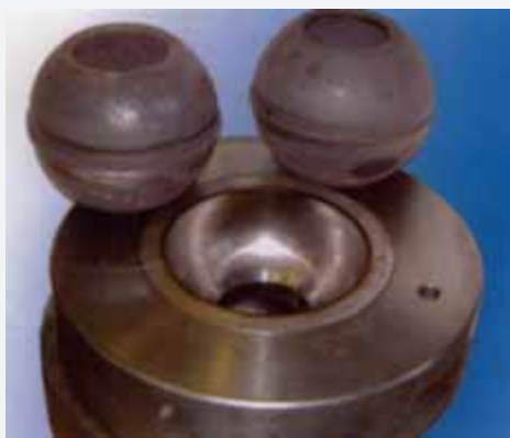
Рис.7. Поковка пробки шаровой на DN 125 и полуматрица штампа
