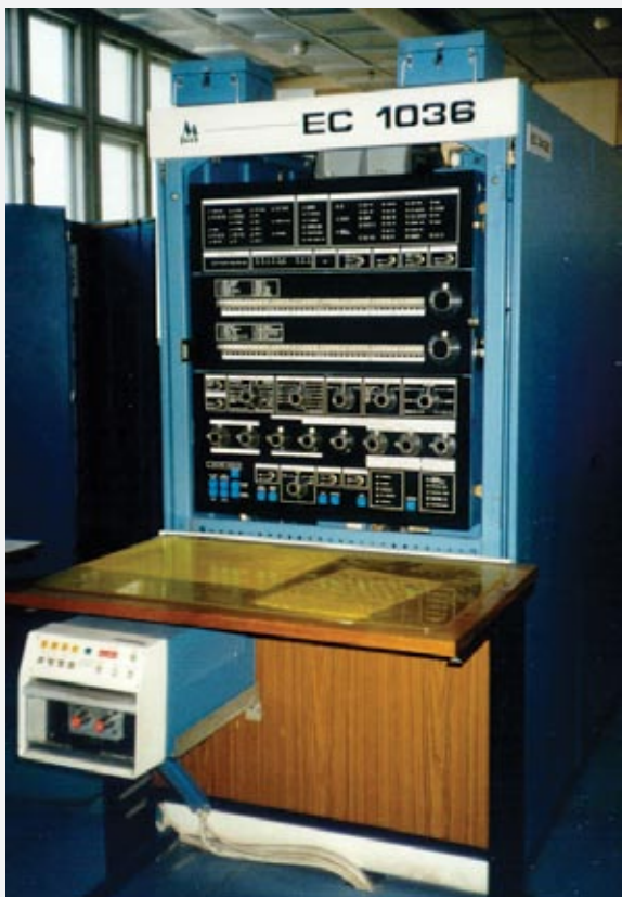
Пульт управления ЕС-1036. Техническую базу советских АСУП 1980-х гг. составляли, в основном, ЕС и СМ ЭВМ. (Фото www.bashedu.ru )
