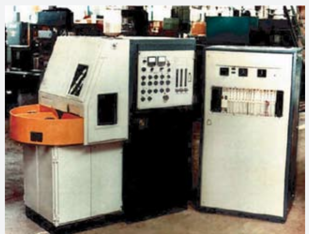
Рис. 9. Автоматическая установка УП-142 для наплавки деталей арматуры
