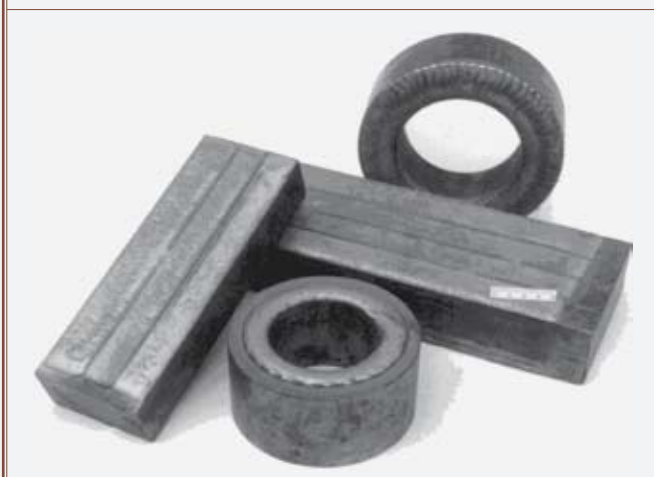
Рис. 6. Седла и шиберы фонтанных задвижек DN 50, наплавленные плазменно-порошковым методом
