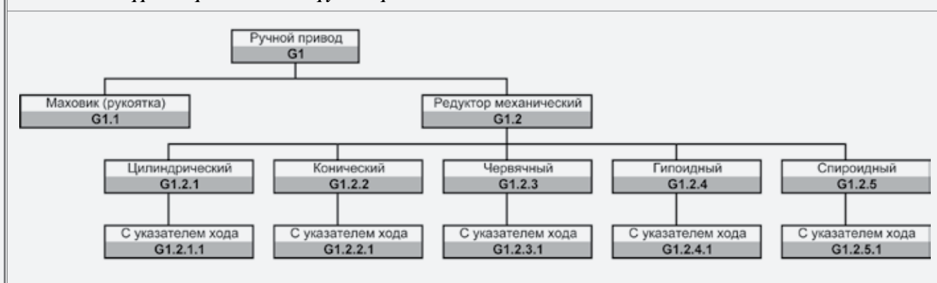
Рис. 9. Расшифровка признака «G1» – ручной привод
