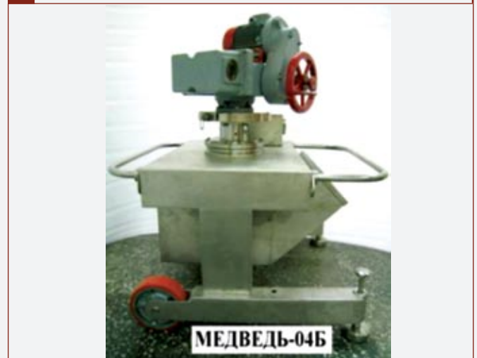
Рис. 2. Стенд с установленным на нем электроприводом
