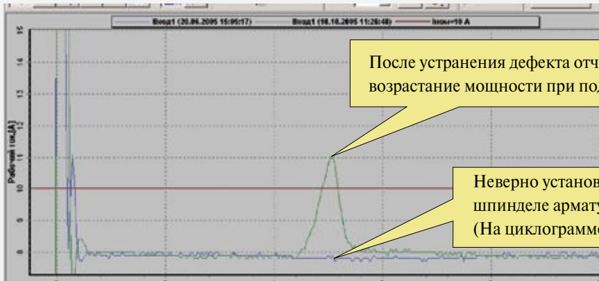
Пример 4. Задвижка Чеховского завода 895 – 400 – ЭА (сравнение диагностических измерений до ремонта и после)
