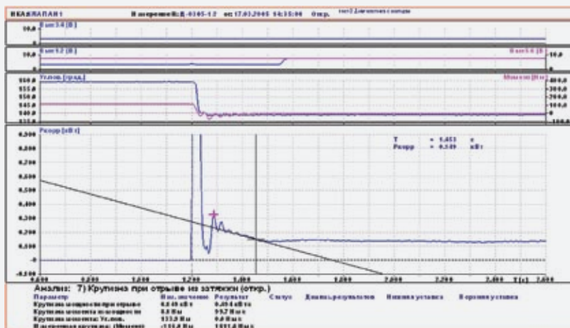
Рис. 7. Фрагмент анализа данных. Анализ характерной точки – отрыв из затяжки (смена флангов резьбы и начало разгрузки шпинделя – точка 6 Рис. 1)
