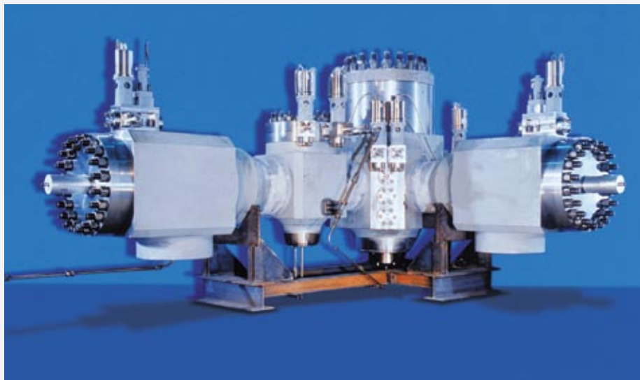
AVVER – главный комбинированный паровой клапан производства фирмы CCI. AVVER представляет собой комбинированный модуль, назначение которого сократить время монтажа. В него входят: главный запорный паровой клапан, главный предохранительный перепускной клапан и быстродействующий перепускной клапан пара, управляемый приводом.
