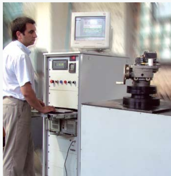
Настройка и компьютерная диагностика опытного образца неполноповоротного электропривода в экспериментальной лаборатории ЗАО ИТЦ «Привод»
