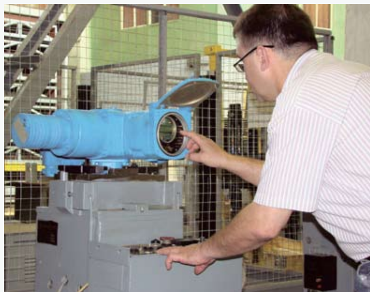
Настройка и диагностика электропривода новой серии ЭП4
