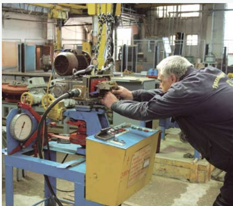
Приемо-сдаточные испытания электропривода традиционной серии
