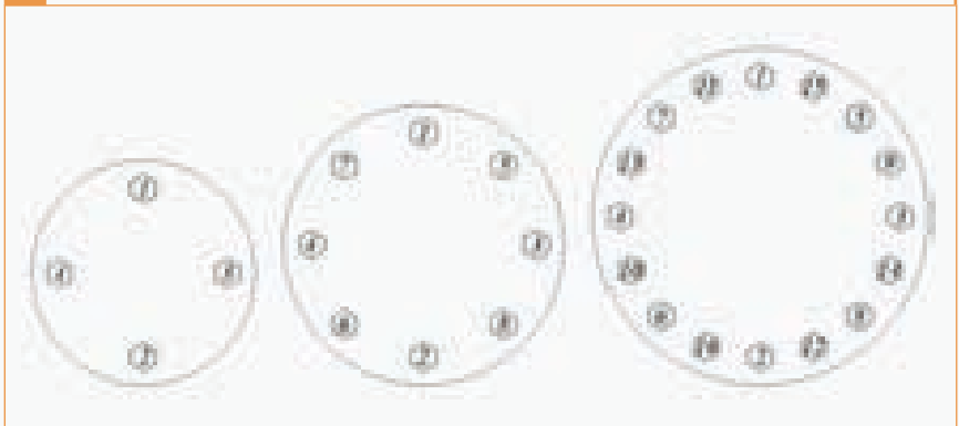
Рис. 7. Порядок затяжки болтов (шпилек) во фланцевом соединении
