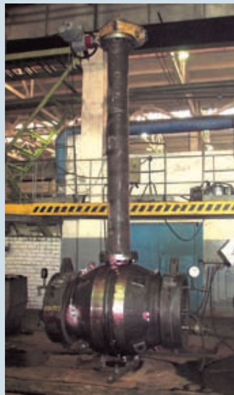
Промежуточные испытания шарового крана DN 800 PN 6.4 МПа
