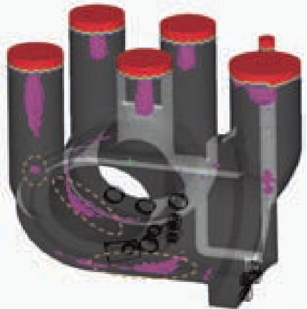
Рис. 4. Распределение усадочных дефектов в теле отливки
