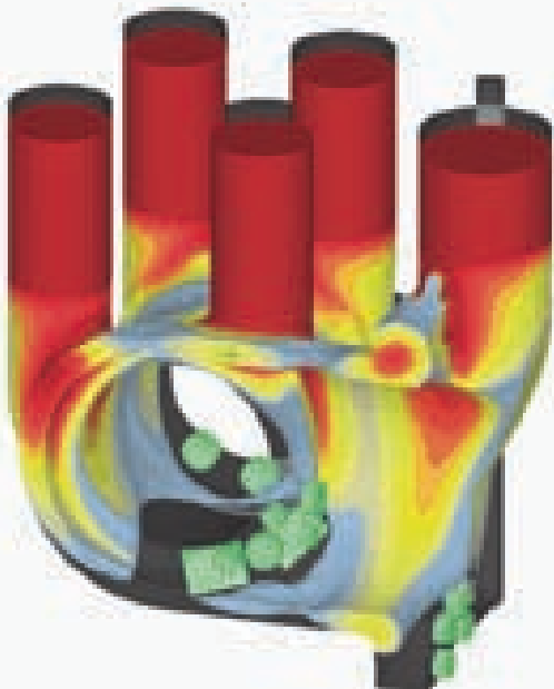
Рис. 3. Кристаллизация сплава в ProCAST
