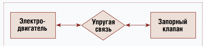
Рис. 2. Упрощенная модель арматуры с электроприводом
