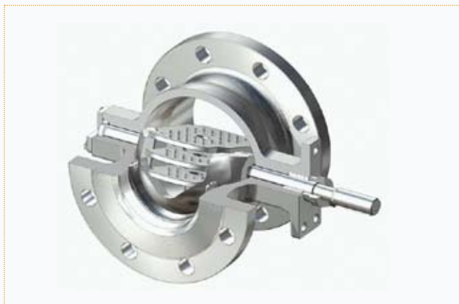
Рис. 4. Клапан с сегментным затвором Q-trim® фирмы Neles, позволяющим снизить уровень шума и кавитации
