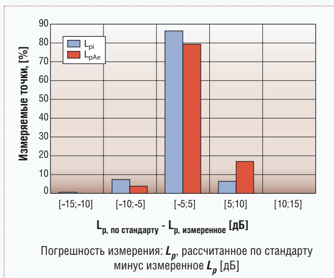
Рис. 7. Точность расчетов по стандарту IEC 60534-8-3 с внесенными изменениями, представленными в разделе 2 (таблица 1, таблица 2, \Delta TL – см. уравнение (11))
