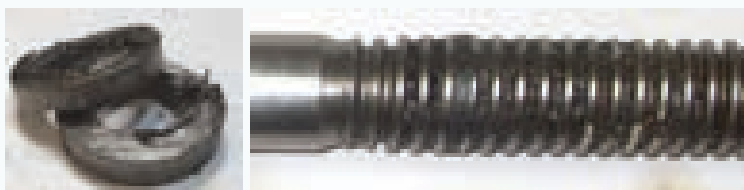
Рис. 1. Набивка сальника и шпindel со следами набивки в резьбе
