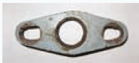
Рис. 9. Фланец сальника (отверстия под шпильки имеют неправильную форму)
