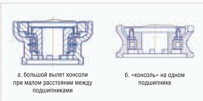
Рис. 4. Некорректные исполнения консольных валов
