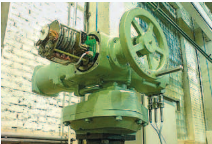
Рис. 2. Привод ЭП4 для АЭС 2000 Нм, 32 об/мин, исполнение – для гермозоны, со вскрытым блоком выключателей
