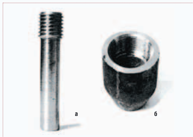
Рис. 9. Внешний вид наконечника фидера (а) и сопла поворотной газовой горелки (б)
