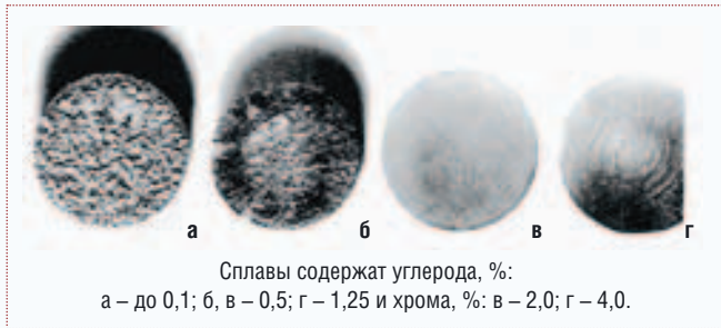
Рис. 6. Состояние поверхности образцов после окисления при температуре 1100° С в течение 1000 часов
