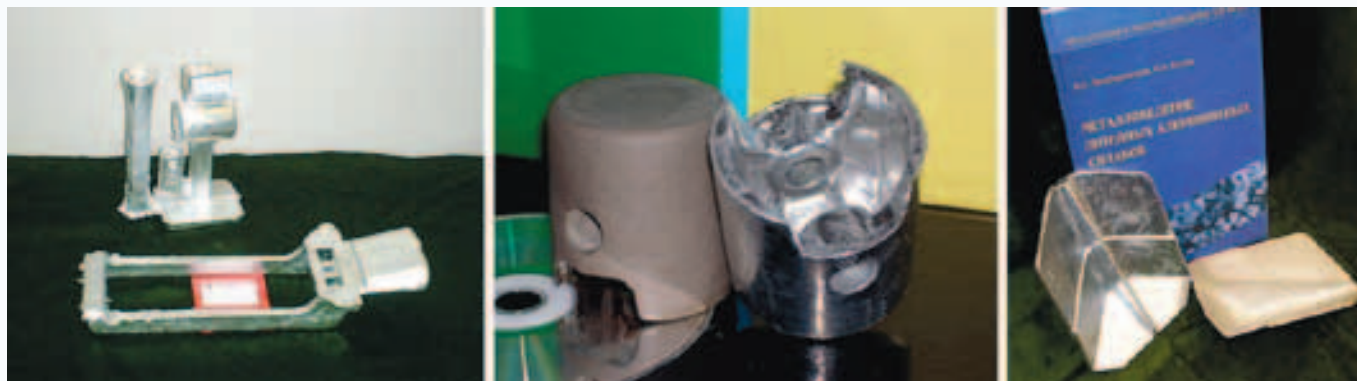
Рис. 2. Примеры тонкостенных отливок из никалина АН4Мц2 (в том числе с ПЭО-покрытием)
