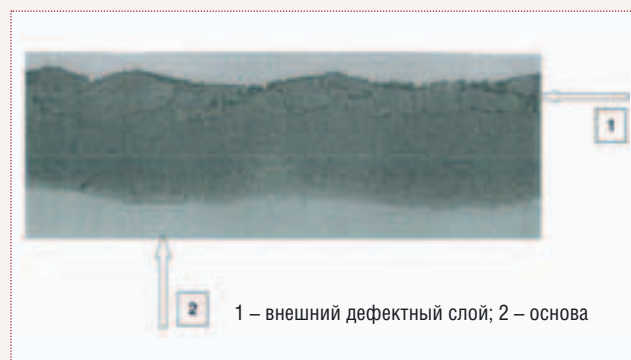
Рис. 1. Поперечный шлиф ПЭО-покрытия (Keronite). Основа, сплав 7075, толщина 120 мкм
