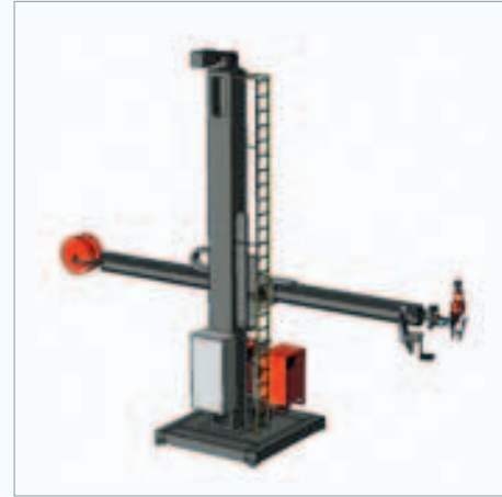
Рис. 10. Сварочная консольно-поворотная балка. Сварка под слоем флюса
