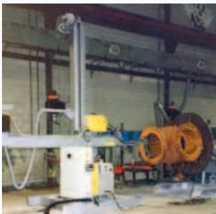
Рис. 1. Автоматизация сварки корпуса крана, обслуживают установку 2 человека
