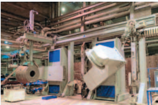
Рис. 3. Портальный комплекс с 2-мя рабочими местами. Эффективность работы более 90%
