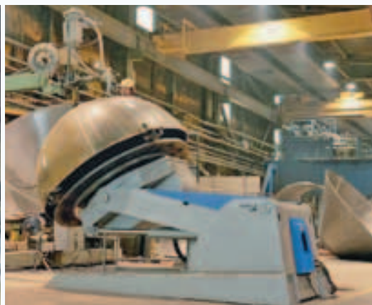
Рис. 2. Совместное применение 3-х осевого вращателя и сварочной колонны для сварки тел вращения
