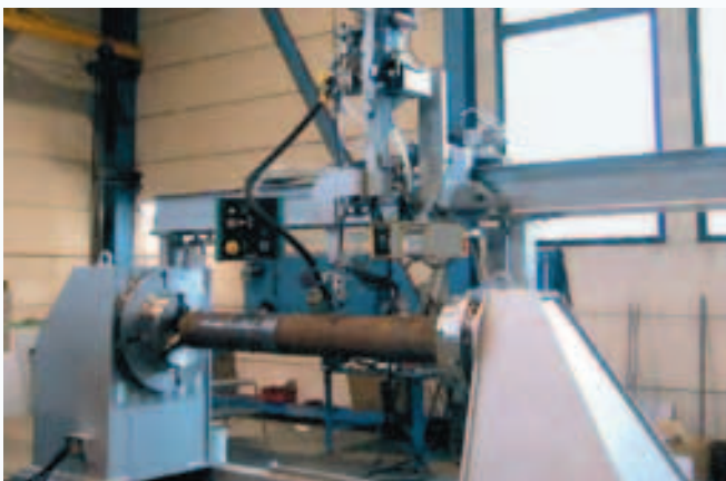
Рис. 4. Установка с ручным управлением сварочным оборудованием. Повышается качество сварки
