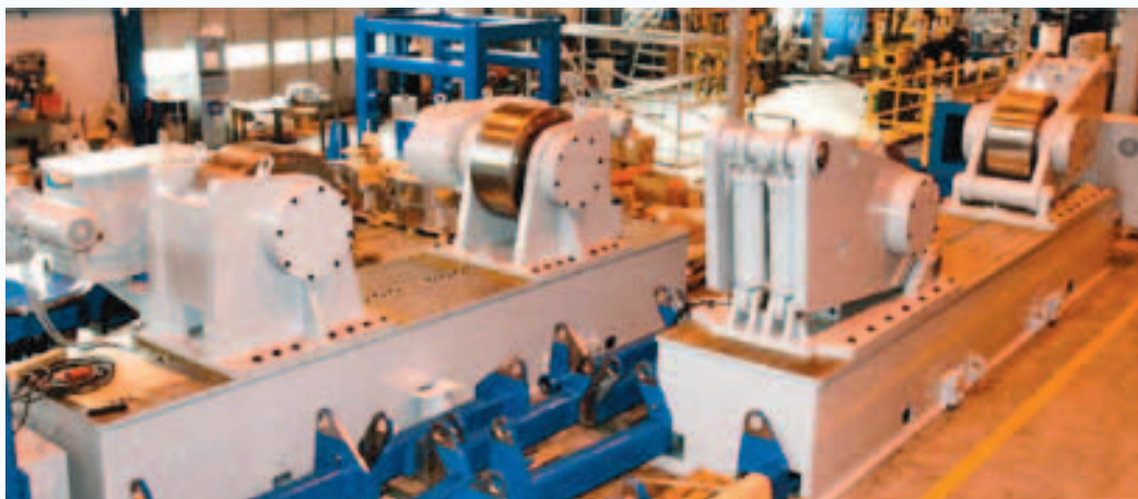
Рис. 12. Роликовые опоры обеспечивают равномерное вращение заготовки
