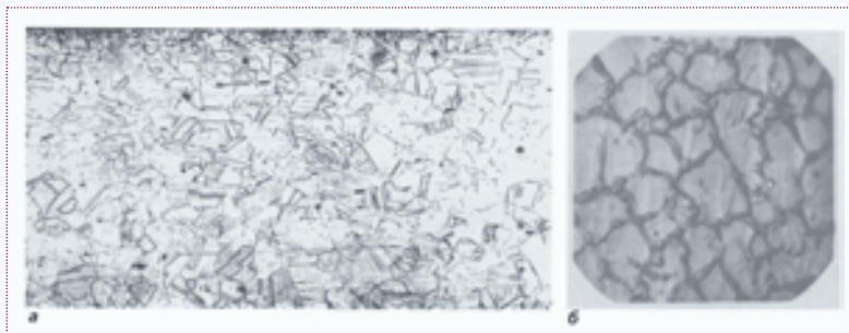
Рис. 1. Микроструктура стали типа 18-10: а) не склонна к МКК; б) склонна к МКК
