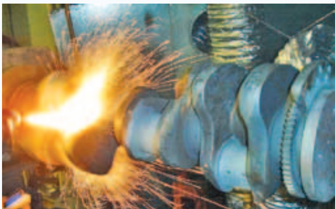
Рис. 6. Восстановление коленчатого вала двигателя КамАЗ
