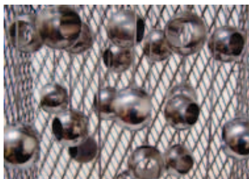
Рис. 4. Шары DN 32 из нержавеющей стали, прошедшие ПАИТ
