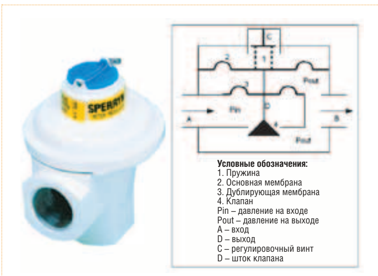
Рис. 1. Регулятор газа (коммунальных систем газоснабжения) и его состав
