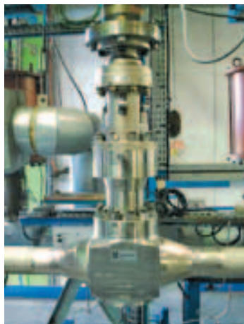
а) чертеж фланцевого соединения корпус-крышка; б) клапан на стенде EDF R&D
