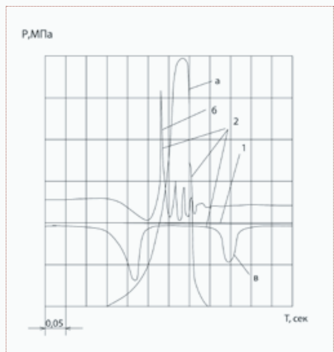
Рис. 6. Виды гидравлических ударов в криогенных системах: а) в тупиковом отводе; б) при гейзерном выбросе криопродукта и открытии клапана; в) при транспортировании жидкости с паровыми включениями; 1 – давление в магистрали; 2 – давление в системе при появлении неустановившихся процессов
