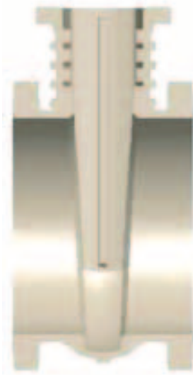
Рис. 2. Ребра, позволяющие соблюсти условия прочности и хладотекучести
