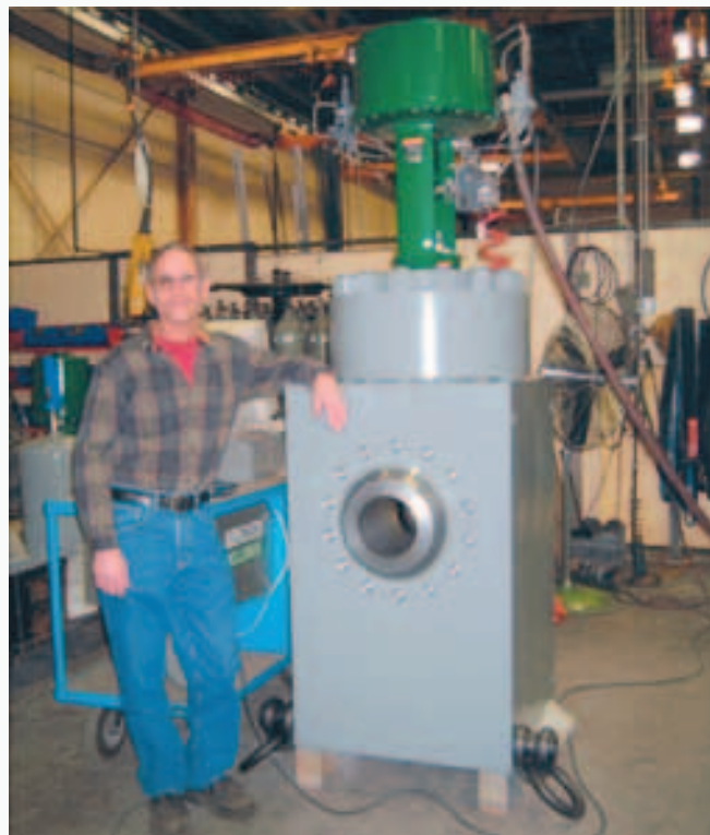
Два уникальных цельнокованых клапана, способных не допускать кавитации при перепаде давления 550 атм, разработаны по специальному заказу для электростанции в Денвере, штат Колорадо
