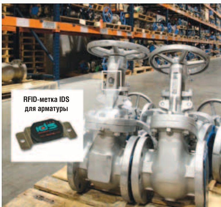
Рис. 1. Метка RFID, прикрепленная к кронштейну задвижки, позволяет дистанционно отслеживать ее перемещение и сохранять информацию в базе данных
