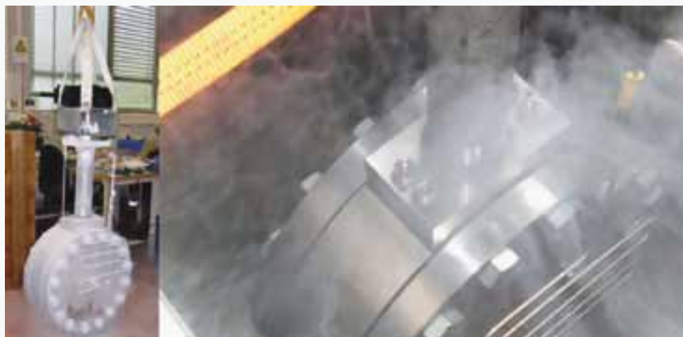
Испытание дисковых затворов QUADAX при криогенной температуре в соответствии с требованиями BS 6364. Утечек нет
