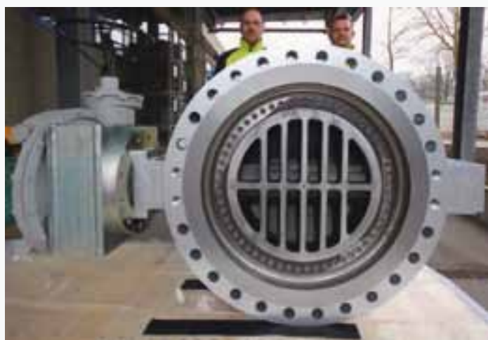
Поворотный дисковый затвор с четырьмя эксцентриситетами QUADAX DN 42". Абсолютная герметичность в обоих направлениях подачи среды до класса давления ANSI 600
