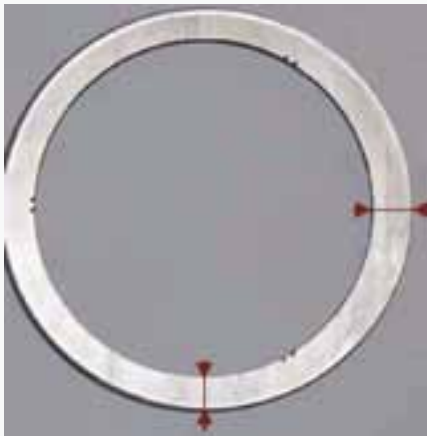
Типичное уплотнительное покрытие поворотного дискового затвора с тройным эксцентриситетом. Большая разница в сечении стенок вызывает несимметричную усадку
