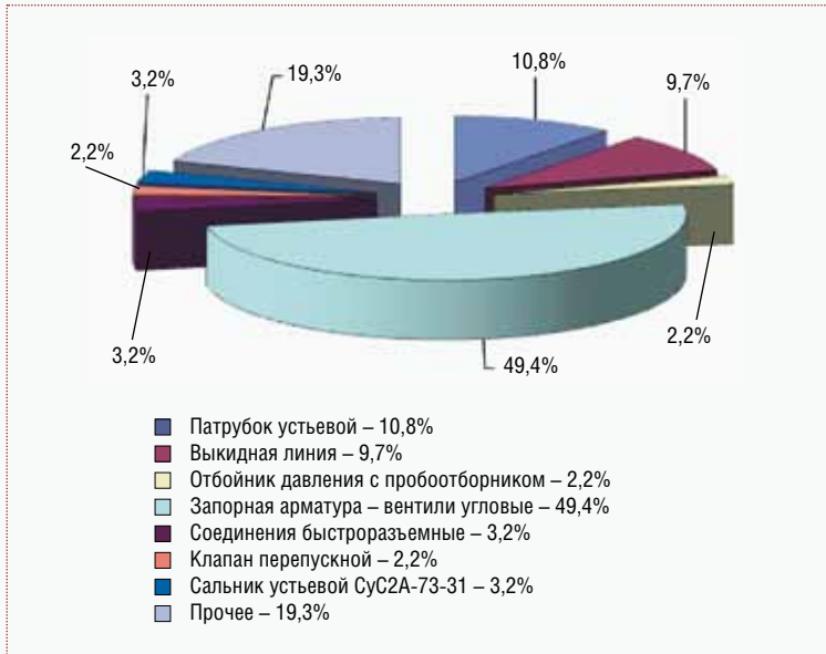
Рис. 3. Распределение дефектов по узлам и элементам обследованной устьевой арматуры типа АУШГН
